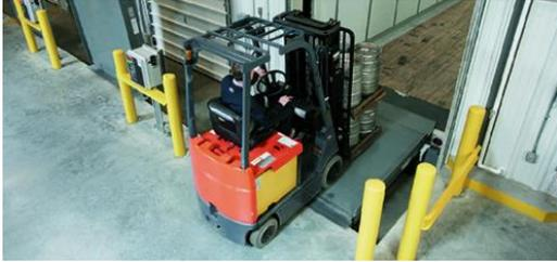
2. Nunca debemos de llevar pasajeros con nosotros en el montacargas. Un montacargas debe estar operado y montado sólo por una persona.
