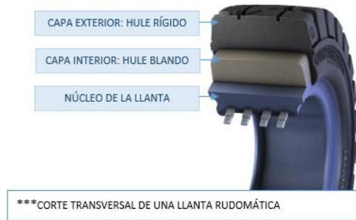
Cuando se deteriora completamente la capa externa de la llanta, esta no disipará las vibraciones apropiadamente, por lo que repercutirá directamente en el eje direccional del equipo. Además de que el hule blando (capa intermedia) no resiste la abrasión como la capa exterior, por lo que empezará a caerse a pedazos mucho más rápido.
